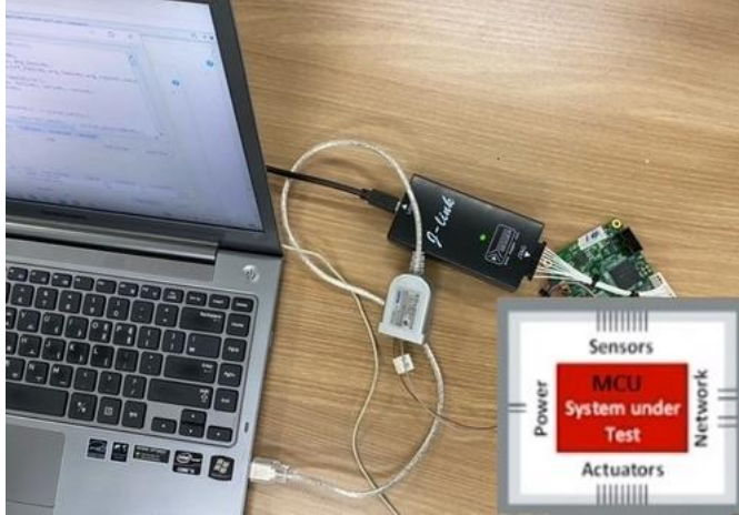
소프트4소프트의 펌웨어 GUI 시스템 테스트 도구.
